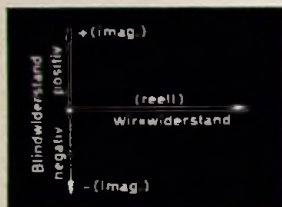
Bild 4. Diagramm zur Ermittlung des Parallelwiderstandes von Spule und Widerstand; Z_p ist der resultierende Widerstand der Parallelschaltung
