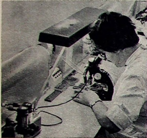
Bild 5. Beschicken von Legierungsformen mit Germaniumplättchen und Indiumkugeln
