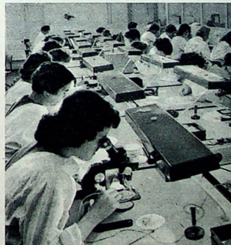
Bild 3. Optische Kontrolle der Kristallplättchen unter dem Binokular-Mikroskop
