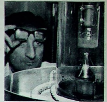
Bild 1. Teil einer Ziehapparat für Germanium-Einkristalle. Durch den Glasschutzzyylinder blickt man in die Germaniumschmelze, aus der mittels eines Impfkristalls der Germanium-Einkristall-Stab gezogen wird
